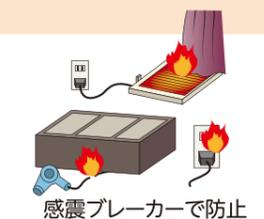
あらかじめ設定した震度以上の地震が発生した場合に、自動的に電気の供給を遮断しますので、電気による出火防止に効果的です。
