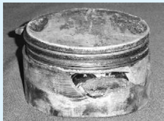
零戦62型の「栄」31型系統発動機ピストン
